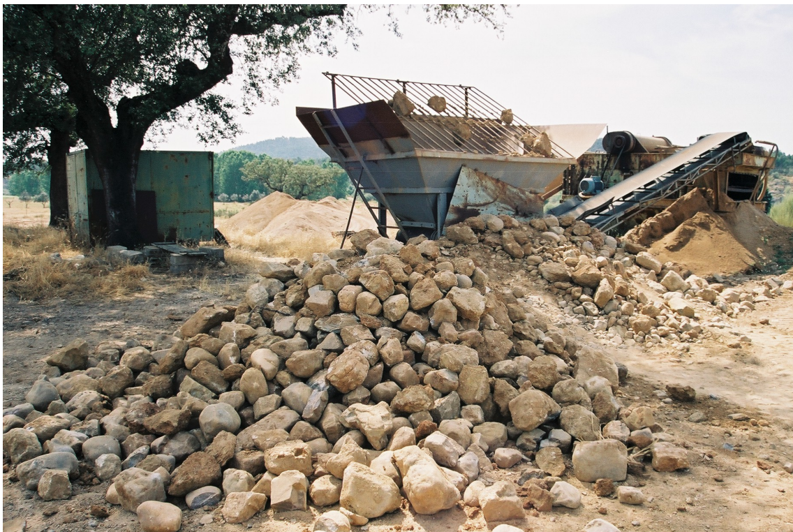
Fotografia 5 – Maquinaria de separação de inertes no areeiro das Casas do Sordão – Monte Escrivão.
