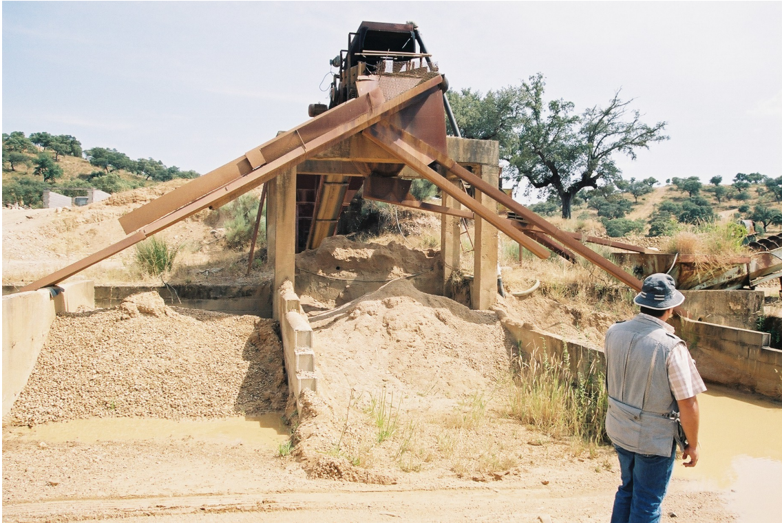
Fotografia 5 – Maquinaria de separação de inertes no areeiro das Casas do Sordão – Monte Escrivão.
